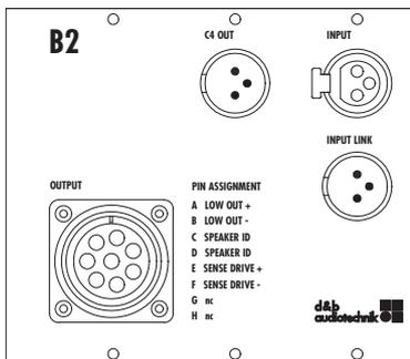
**Fig. 5: Partie arrière des commandes du B2-SUB**
