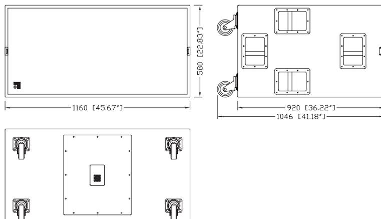
Fig. 7: B2-SUB dimensions du coffre en mm [inch]
