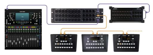
SQ étendue avec 2 x DX168 pour un fonctionnement à 96 kHz 32 entrées déportées + 16 sorties déportées
